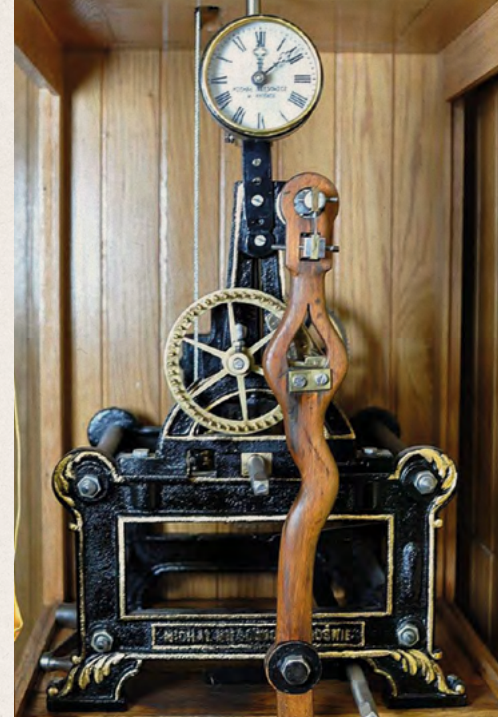
Zrekonstruowany mechanizm zegara wieżowego znajdujący się w krośnieńskim Muzeum Rzemiosła.
